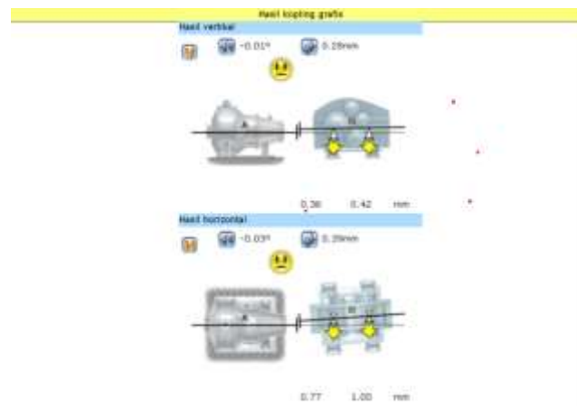
Gambar 3. 17 Hasil rekaman laser aligment (Sumber : alat laser aligment profteknik di PT SEML)
