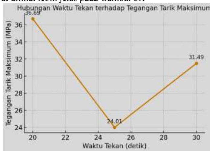
Gambar 5.1 Grafik Tegangan Tarik Rata-Rata Maksimum Dari Spesimen Waktu Tekan 20, 25 dan 30 detik
