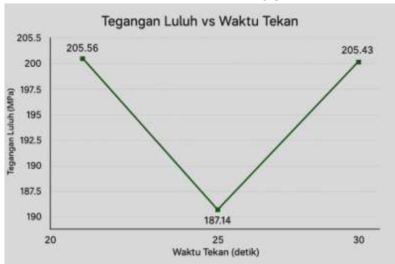
Gambar 5.3 Grafik Tegangan Luluh Rata-Rata Dari Spesimen Waktu Tekan 20, 25 dan 30 detik
