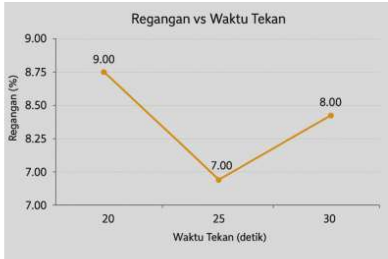
Gambar 5. 2 Grafik Regangan Rata-Rata Maksimum Dari Spesimen Waktu Tekan 20, 25 dan 30 detik
