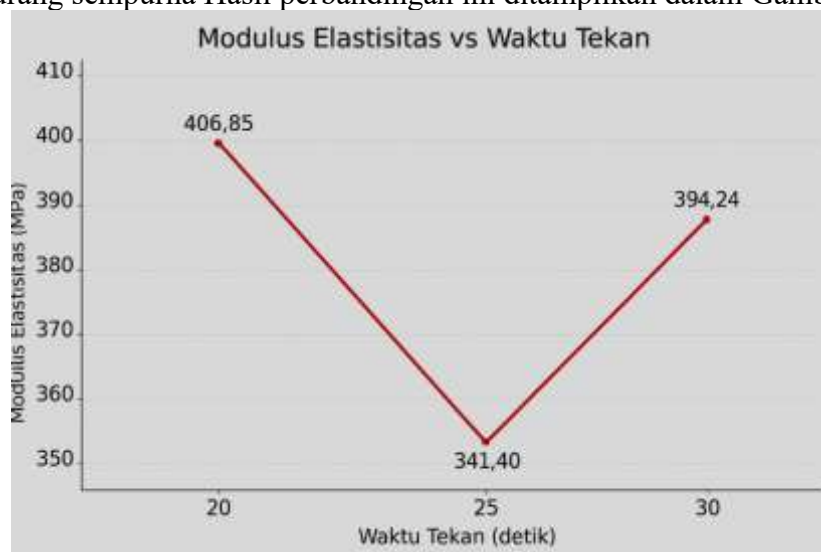
Gambar 5. 4 Grafik Modulus Elastisitas Rata – Rata Dari Spesimen Waktu Tekan 20, 25 Dan 30 Detik
