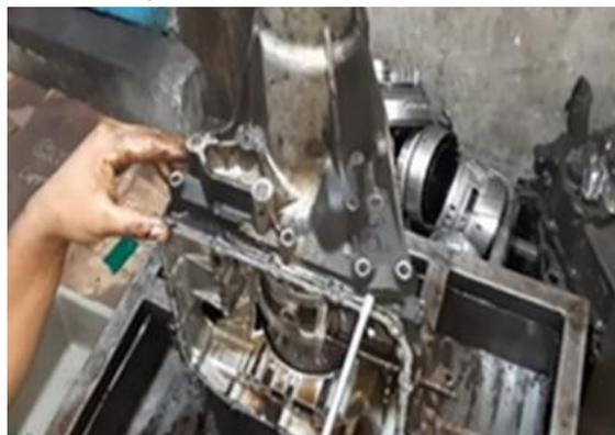
**Gambar 5. Pembongkaran Transmisi**
