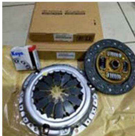
**Gambar 8. Cover Clutch dan Plat Kopling**
