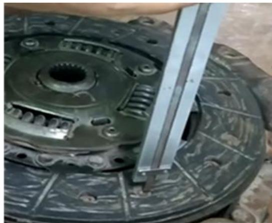
**Gambar 11. Pengukuran Plat Kopling**
