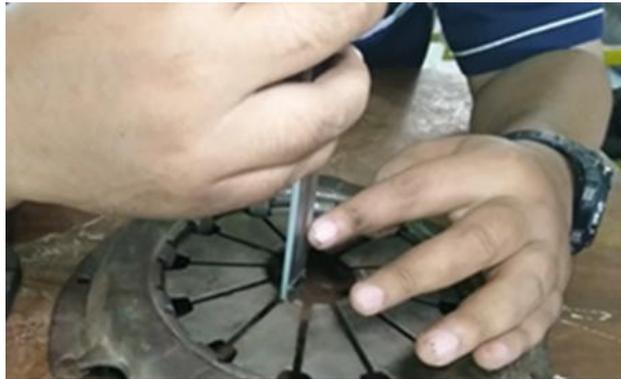
**Gambar 10. Pengukuran Keausan Clutch Cover Dengan Jangka Sorong**
