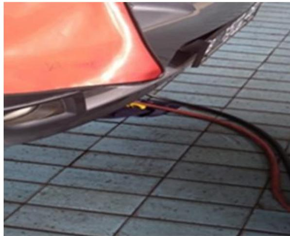
**Gambar 2. Tempat Masuk dan Keluarnya ATF Pada Alat Flushing**
